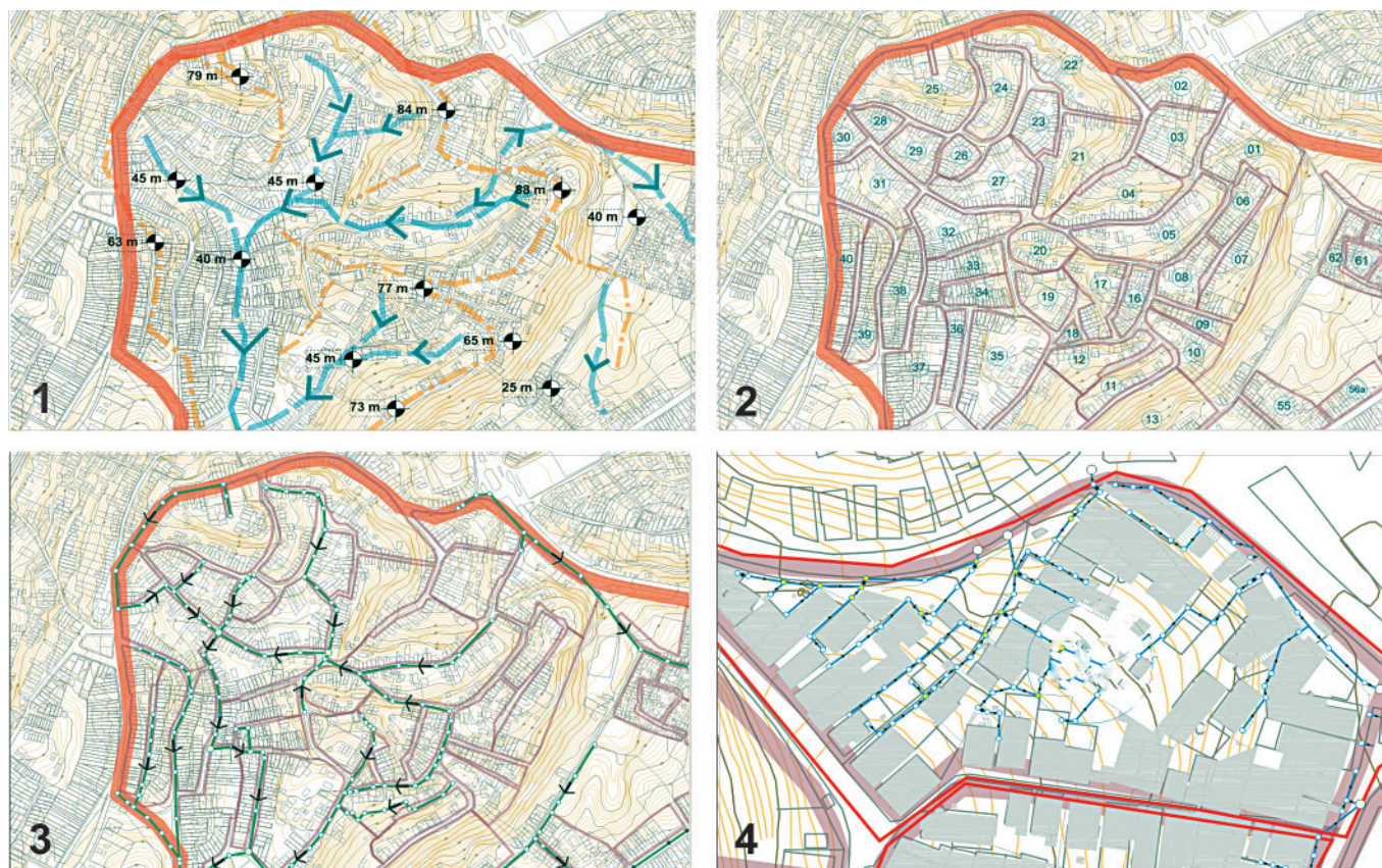
Figura 83 Fases del trabajo en un micro-sistema, sucesivamente: apreciación de su topografía y sus causas naturales (1); delimitación de sus condominios (2); lanzamiento de su red básica (3); y el ramal de un condominio (4)
