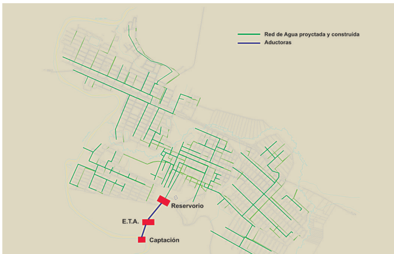
Figura 104 El sistema condominial de distribución de agua, alcanzando toda la área urbana Fuente: CONDOMINIUM/VALE
